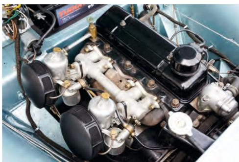
**Le moteur semble tout juste sorti d'usine ! Développant 90 ch et alimenté par deux carburateurs SU H4, il respire mieux que les moteurs suivants, pourtant plus puissants.**
